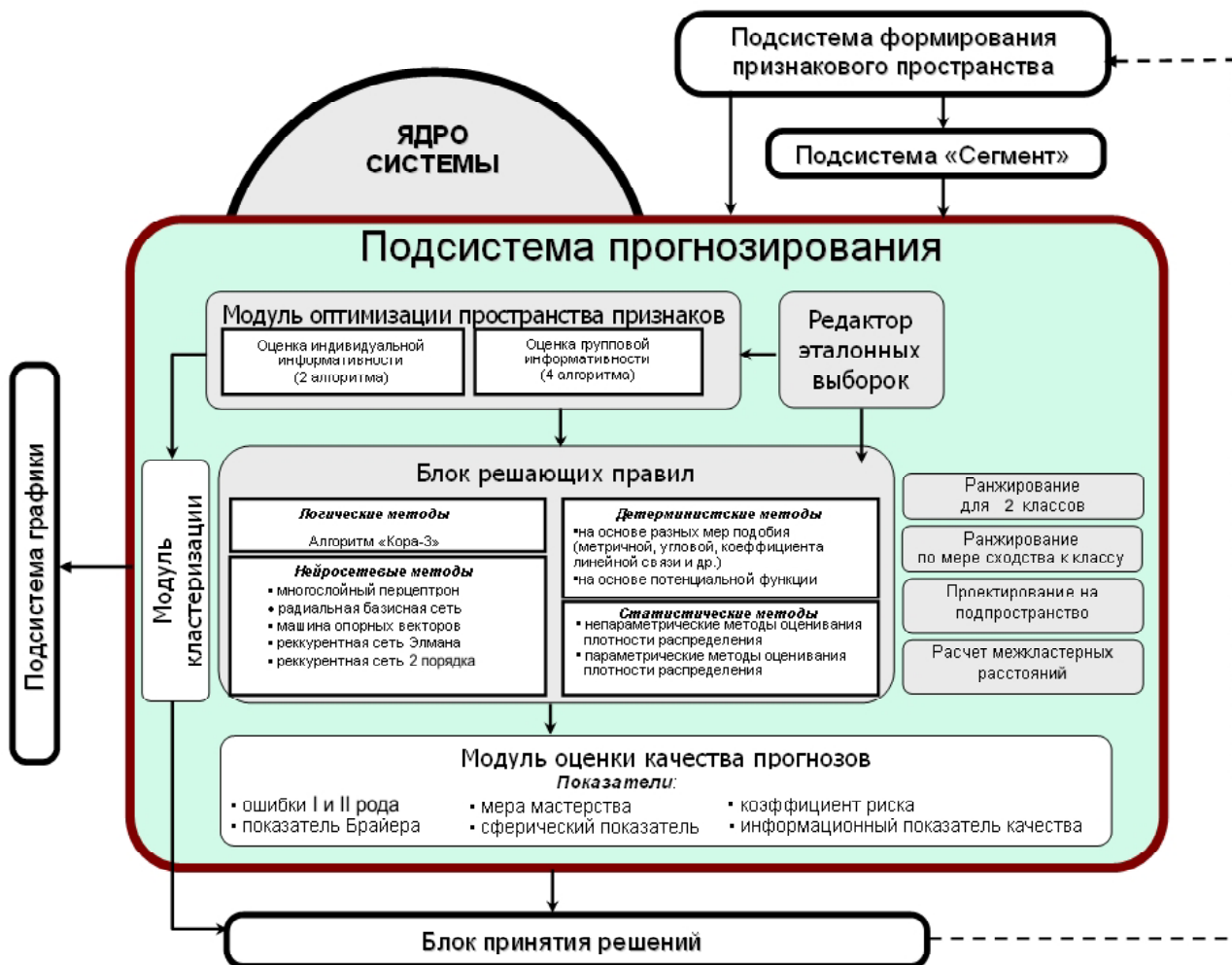
Рис. 5. Функциональная схема подсистемы прогнозирования
